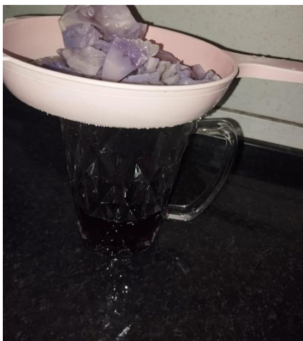
Figura 02. Imagem do processo de filtração do repolho roxo após o seu cozimento.
