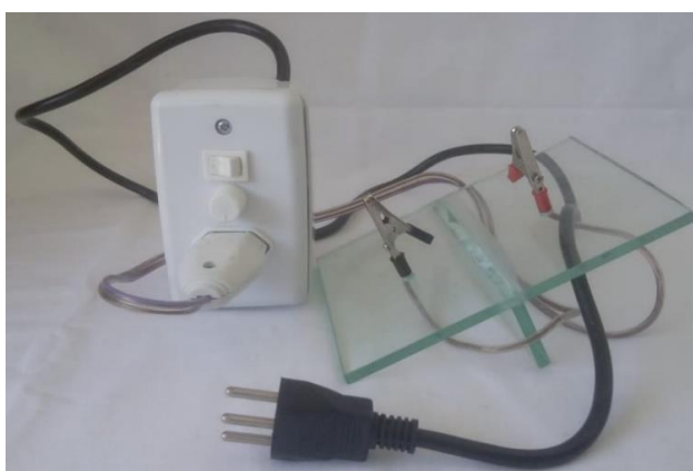
Figura 5 – Fio condutor preso à tampa e ao dimmer
