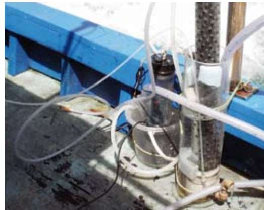
Equilibrador para medição contínua de pressão parcial de CO 2 e variáveis físico-químicas da água do mar.
